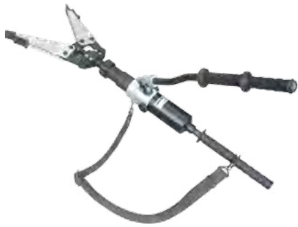
СПИН с установленной насадкой РБС-1 и удлинительными рукоятками
