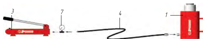
Система с одним рабочим механизмом одностороннего действия
