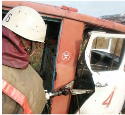
СПИН с установленной насадкой РБС-1 и удлинительными рукоятками
